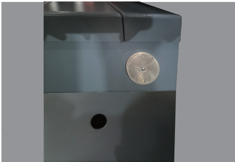
红外同步保护装置，防止车辆侧翻
