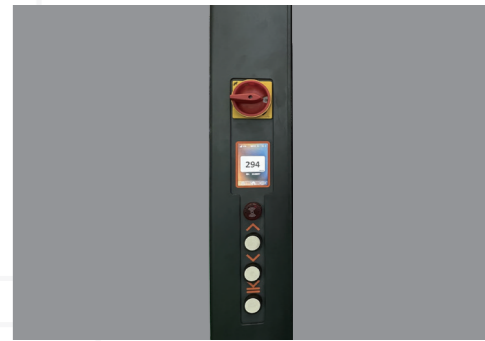
24V低压控制系统, 安全操作 二次下降操作系统, 有效预防意外伤害
