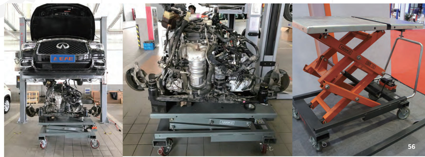
带方向锁的万向轮 平台配有4支高承载脚轮, 配有方向锁, 定向轮与万向轮之间可快速切换, 移动轻便自由
