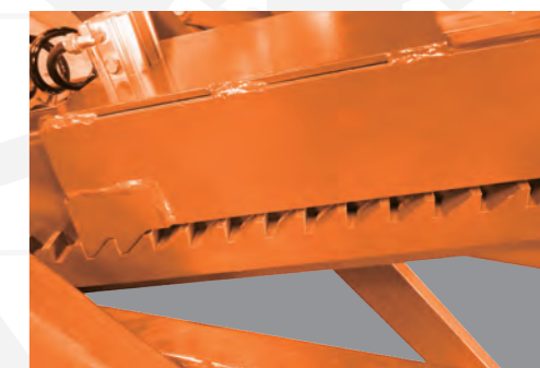
机械锁和气动解锁装置
