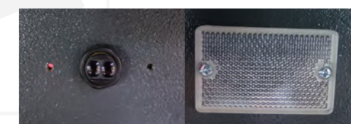
红外同步保护装置, 预防平台不同步运行导致事故
