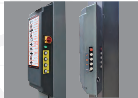
低压(24V)控制系统和辅控制系统
