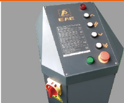
低压 (24V) 控制系统, 急停按钮
