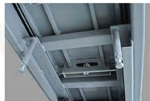
调平螺栓, 能在安装完成后, 二次调整举升机平台的水平度
