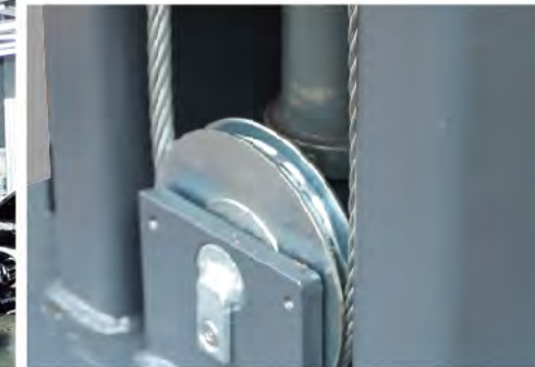
滑轮脱轨保护装置
