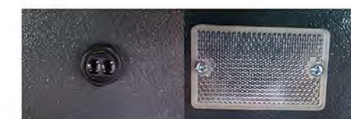
红外同步保护装置, 预防平台不同步运行导致事故
