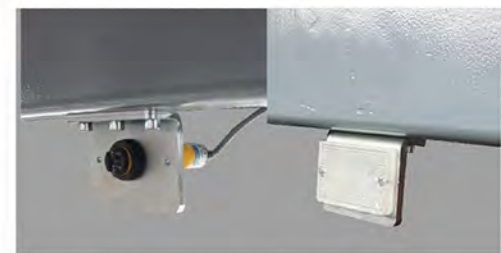
红外同步保护装置, 防止车辆侧翻
