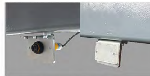
红外同步保护装置, 防止车辆侧翻
