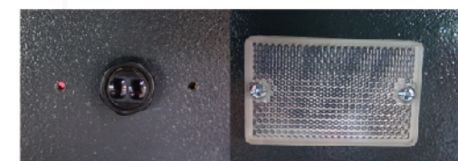
标配红外同步保护装置 预防平台不同步运行导致事故
