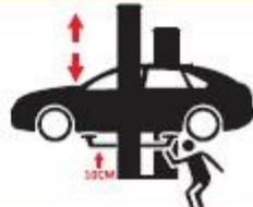
**车辆被举升离地面十公分左右高度后, 停止操作, 确保臂锁已经啮合, 举升托盘没有偏离支撑点, 再举升到希望的高度。**
