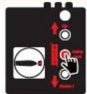
**落锁后才可以到车下工作, 以防液压或者机械故障导致车子突然下落。**
