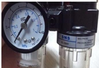
建议向油杯中加入透平 1 号油 (ISO VG32)。使用油杯顶部的旋钮调整滴油量, 将旋钮调到箭头标记指向数字“4”。
