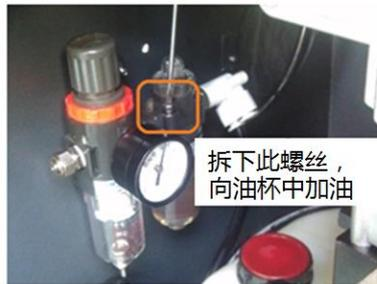
拆下此螺丝, 向油杯中加油
