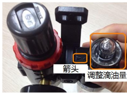
拆下此螺丝, 向油杯中加油
