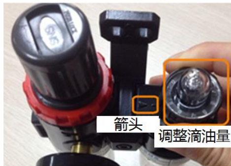
拆下此螺丝, 向油杯中加油
