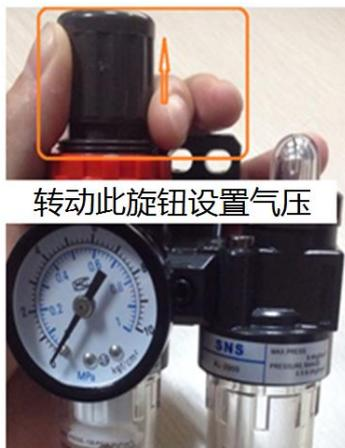
建议向油杯中加入透平 1 号油 (ISO VG32)。使用油杯顶部的旋钮调整滴油量, 将旋钮调到箭头标记指向数字“4”。
