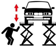
落锁后两边平台要保持相同高度，以免车辆滑落。
