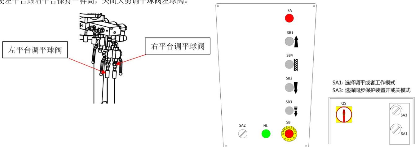
调平小剪平台同步性（为方便调平观察，可将大剪平台下降至最低或者相对合适的高度）
